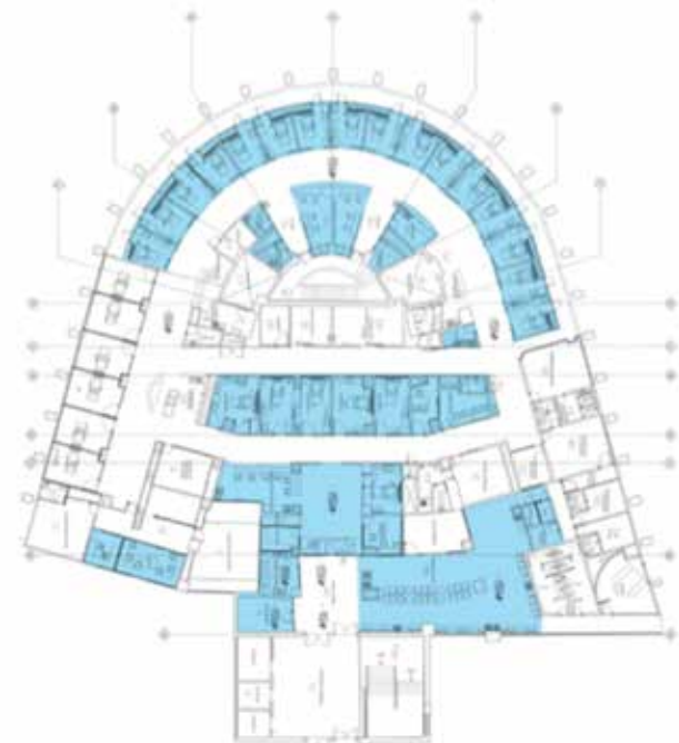
Figura 29. Planta arquitectónica de la remodelación de la Unidad Coronaria. Arco en azul, los cubículos por remodelar; el restante en azul, la ubicación de 6 camas adicionales (central de enfermería) = 27% de incremento en capacidad.
